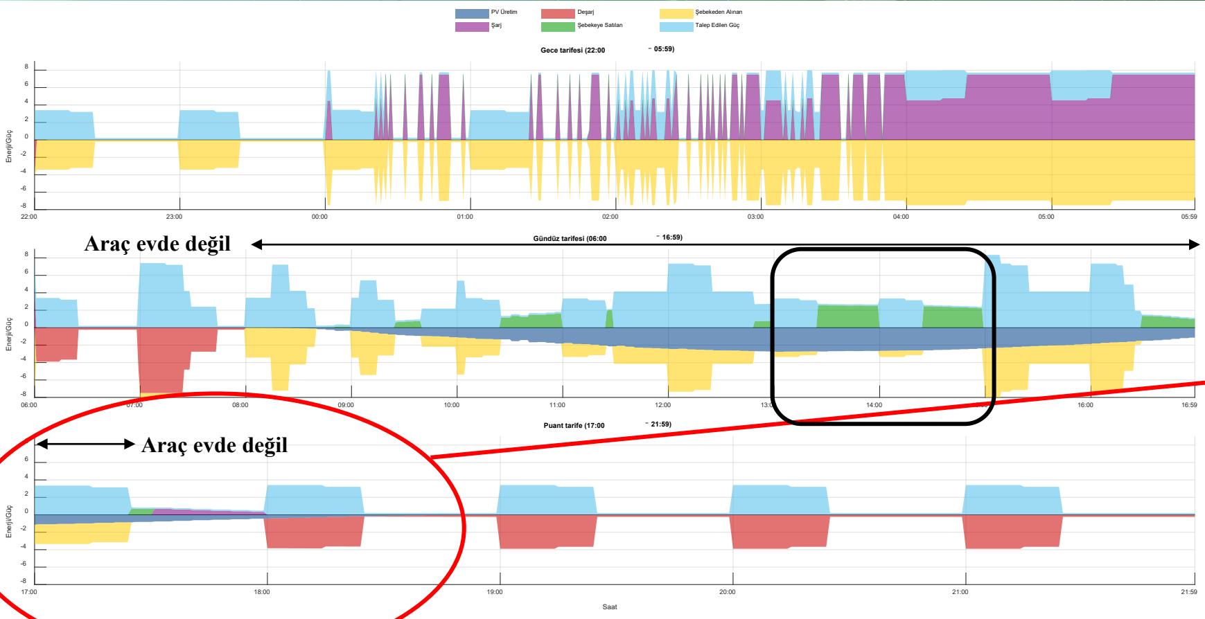
Şekil 7. MILP algoritmasına göre ev enerji akışlarının zamana bağlı değişimi.
