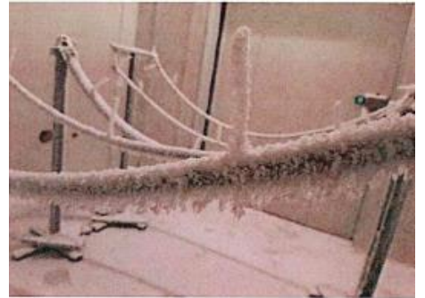
Şekil 2: Yağmur Kaynaklı Buzlanma (Freezing Rain) Testi sonrası numune yüzeyindeki kırağı tabakası
