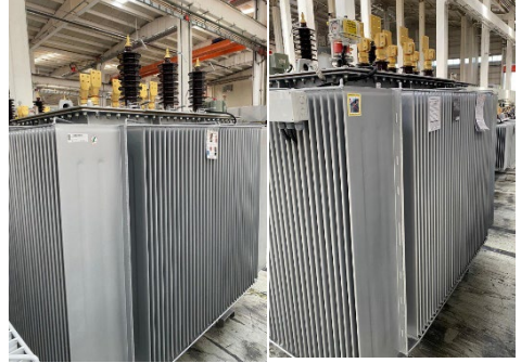
Şekil 1. 800 V alçak gerilimli IEC transformatörü.
